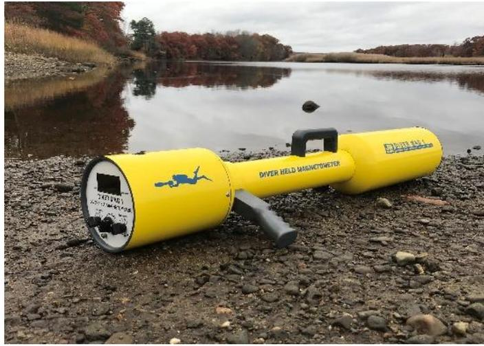
DIVER MAG 1 是一款由优异性能微处理器驱动的海洋磁力探测系统，具有一个伽马的灵敏度。它是一款手持式超灵敏的黑色金属(铁/钢)探测器，在陆地或水下均能正常工作。DIVER MAG 1 能够定位管道，电缆，大炮，疏浚部件以及任何大小的黑色金属物体。它结构坚固，适用于商业运用，其用户友好的设计也便于操作。配备的手柄使其便于在陆地上携带。
