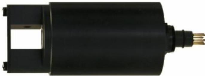
Seapoint 叶绿素荧光计（SCF）可以在有泵或无泵的情况下操作，感应区域可以开放在水体中直接使用，或者在订购泵送版本的情况下通过泵送水进行测量。SCF 使用调制蓝色 LED 灯和蓝色激发滤光片来激发叶绿素 a。叶绿素 a 发出的荧光通过红色发射滤光片，并由硅光电二极管检测。然后处理低电平信号。传感器有多个量程可供选择，用户可以根据指导自行更改量程。
