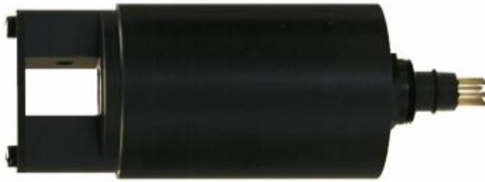
荧光素荧光计（SFF）可以在有或无泵的情况下操作，感应区域可以开放在水体中直接使用，或者在订购泵送版本的情况下通过泵送水进行测量。SFF 使用调制 LED 灯和激发滤光片来激发水中的荧光素。荧光素发出的荧光通过发射滤光片，并由硅光电二极管检测。低电平信号然后通过同步解调电路处理，生成输出，其电压与荧光素浓度成正比。传感器有多个量程可供选择，用户可以根据指导自行更改量程。
