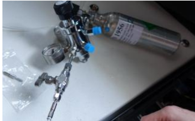
外置式标气校准模块
