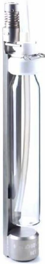
MICROS 水样采集器(玻璃采水器)是一款结构简单、操作便捷的水样采集设备,适用于 100m 以内的水深采样。采样器的形状非常细长,甚至可以从直径为 8cm 的孔中进行采样。MICROS 水样采集器还有一个特性就是,它可以在高压灭菌锅中灭菌,确保样品不会污染杂菌。MICROS 水样采集器由一个不锈钢主体,一个特氟龙材料的采样瓶固定器(上面带有硅树脂采样管)和一个容量为 500ml、并且可以更换的玻璃瓶采样瓶组成。处于关闭状态(硅树脂管被夹住)的 MICROS 水样采集器可避免样品在下放过程中被表面水污染。在 MICROS 下水后,当达到预期深度时,一个使锤将会撞击铁砧,这时硅树脂管将会弹起,允许水进入样品瓶,同时将空气排出。研究样品时,将样品瓶从固定器上取下,这样样品瓶之间就不会因为倾倒样品相互影响。
