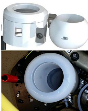
用球形阀代替卡盖封闭采样桶,防止封闭瞬间在桶内造成的压力差影响细菌和微生物活性状态。
