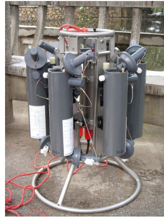
采水前的多通道水样采集器 Slimline
