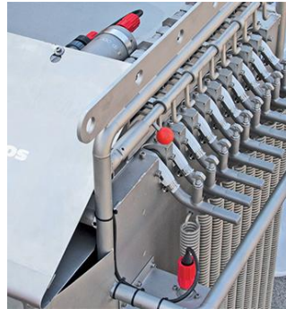
高强度弹簧提供 网口开闭的动力
