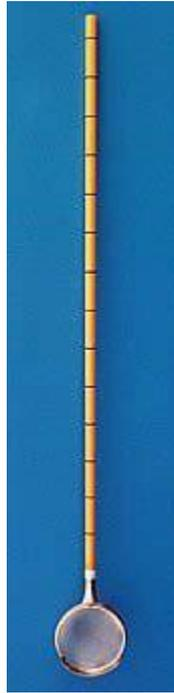
丹麦 KC-Denmark 公司河流底部刮样器由前面直径 20cm 网筛和直径 8mm 的 AISI 316 不锈钢棒组成。网筛容易更换。木轴长 1.5m，经抗酸化处理。
