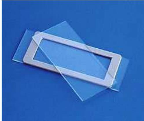
丹麦 KC-Denmark 公司 1ml 浮游生物计数框底玻片玻璃 1mm 厚，76x26mm。计数空间由 1.1mm 的聚酯纤维包围。外周尺寸：70x26mm；内周尺寸：56.8x16mm。盖玻片 1mm 厚，76x26mm。
