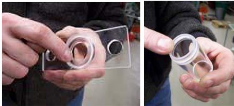
注意：为避免样品泄露，使用前需在基底部涂一层硅脂薄膜
