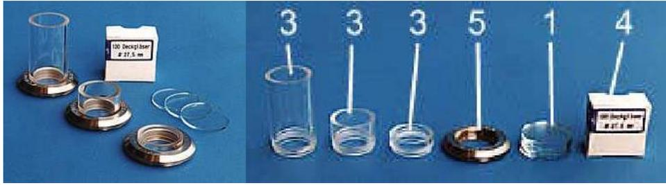
丹麦 KC-Denmark 公司管状浮游生物计数框适合几乎任何类型的倒置显微镜。底板由 AISI 316 不锈钢制造，直径 47/42mm。螺纹：M30。
