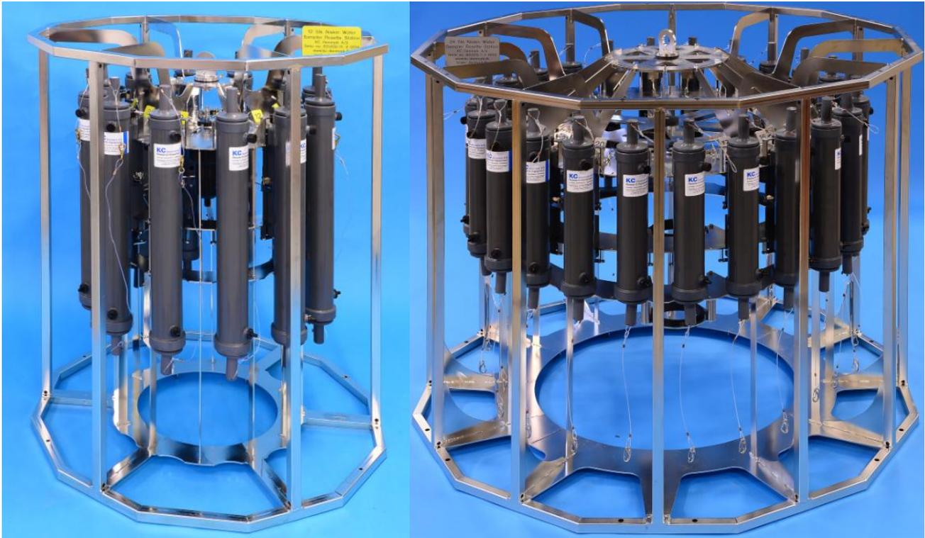
丹麦 KC-Denmark 公司 Rosette 多通道采水器框架材质为 AISI 316 不锈钢，可搭载 6、12 或 24 个 Niskin 采水瓶。释放系统由电机驱动(24V 直流)，可以通过手动触发，也可以事先编好程序，由控制软件触发(60.010-USB 或 60.010-RS-485)。取样管的管身、顶盖及底盖均由 PVC 制成，取样管内部没有任何金属材料。顶盖及底盖通过 1 根橡胶管连接(RS-40 Latex)。
